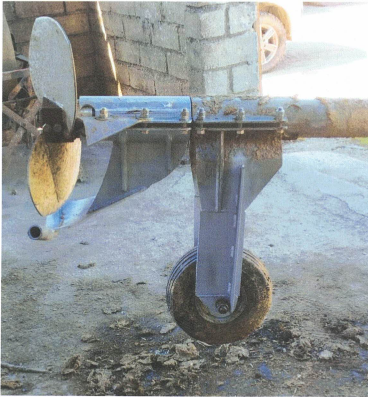
Photo de l'agitateur utilisé pour homogénéiser le digestat avant les transferts et les épandages
